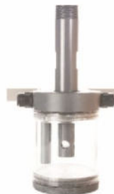
密闭式流通池安装
