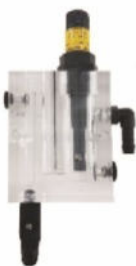
开放式流通池安装
