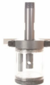
密闭式流通池安装
